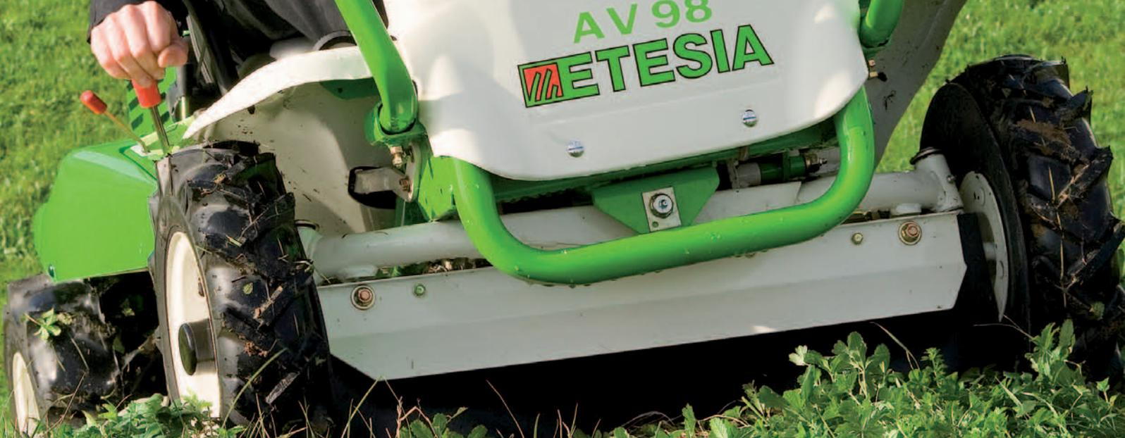
Il modello AV98X è la versione a 4 ruote motrici, con scatola di sterzo rinforzata a lubrificazione stagna ad alta manovrabilità ed una potenza aumentata a 23CV per offrire ancora più trazione sui pendii più impervi.
