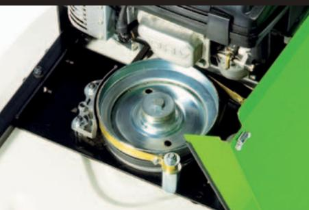
TRASMISSIONE ALL'ORGANO DI TAGLIO TRAMITE CINGHIA PER EVITARE DANNI AL MOTORE IN CASO DI ACCIDENTALE URTO DELLA LAMA
