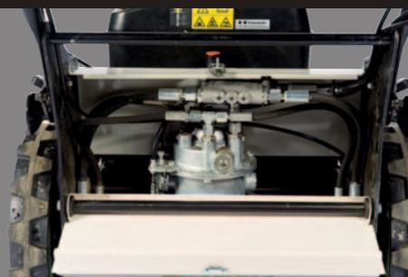
TRASMISSIONE IDRAULICA CON BLOCCAGGIO DEL DIFFERENZIALE
