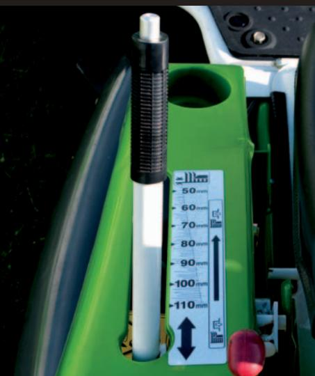
LEVA DI REGOLAZIONE DELLE ALTEZZE DI TAGLIO A 7 POSIZIONI DI LAVORO + 1 POSIZIONE PER I TRASFERIMENTI
