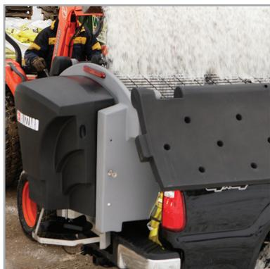
**COPERCHI SOVRAPPosti IN MATERIALE PLASTICO** con canali di scolo per l'acqua. Proteggono il materiale sciogli-ghiaccio da pioggia e neve. La forma a cupola permette di aumentare il volume del materiale trasportato.
