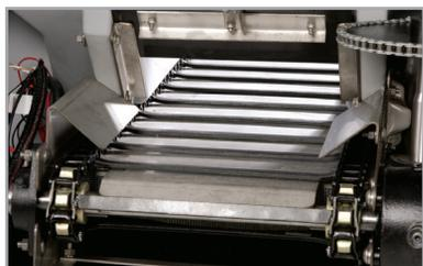
**NASTRO IN ACCIAIO A CATENA** con protezioni in acciaio inossidabile resistente alla corrosione combina un design collaudato con prestazioni leader nel settore.
