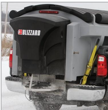
**ESCLUSIVO SCIVOLO DELLA GIRANTE** regolabile in altezza per adattarsi sia ai furgoni cassonati che ai pickup. L'insieme girante è in materiale sintetico anti usura da 394 mm di diametro e può essere rimosso per il rimessaggio.
