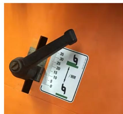
Il dispositivo di regolazione di quanta semente va depositata.
