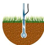
**Lama Interramento Cavo.** Permette di sotterrare senza danni al tappeto erboso il cavo elettrico per i Robot tosaerba.
