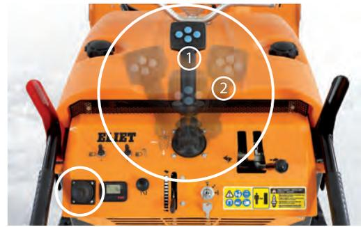
Per la prima volta sul mercato, introduce il joystick, un comando multifunzione in posizione centrale e svolge ben cinque funzioni essenziali per il controllo della turbina da neve:
