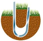
**Lama ad U.** Se desiderate sotterrare l'impianto di irrigazione o un cavo elettrico nel giardino, ELIET vi offre una lama a forma di U idealmente adatta per scavare un fossato temporaneo senza danneggiare troppo il prato. Poiché il fossato può essere facilmente ricoperto con la zolla originale, l'operazione eseguita è molto discreta e non si noterà più dopo breve tempo.
