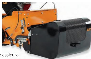
Per eseguire con successo una trattamento di risemina è fondamentale che il seme penetri bene nel terreno. Per scarificare il suolo, ELIET ha scelto delle lame, ad azionamento meccanico, che fanno delle scanalature di 3 mm di larghezza e di circa 15 mm di profondità, indipendentemente dal tipo di terreno o dal grado di umidità. Il lavoro è svolto da diciotto lame fisse con una larghezza di lavoro effettiva di 58 cm.
