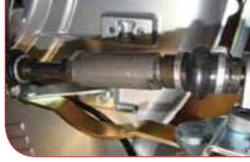
TRASMISSIONE Ad albero cardanico con limitatore di coppia che riduce i contraccolpi e protegge la trasmissione
