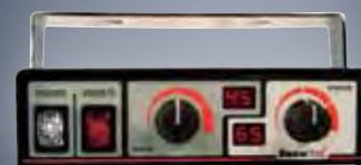
CENTRALINA DI CONTROLLO DELLA VELOCITÀ DELLA GIRANTE E DELLA COCLEA DI ALIMENTAZIONE
